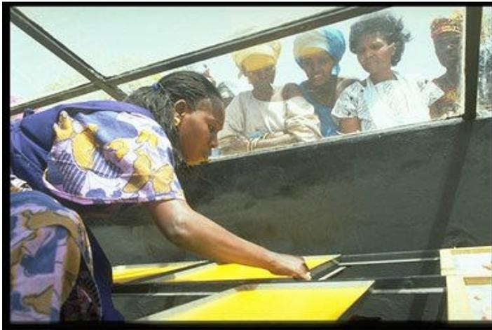
**Photo 1. Femme à l'intérieur d'un four solaire écrasant des mangues et des bananes pour les faire sécher.**
